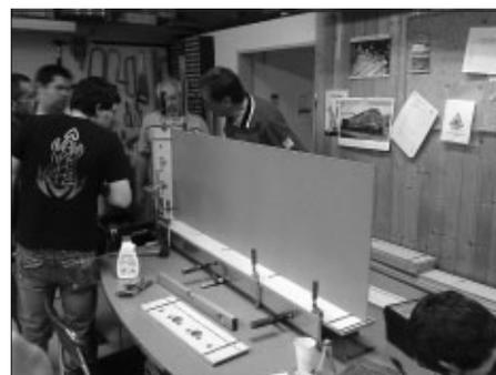
*Zum Verleimen eingespanntes Modul.*
